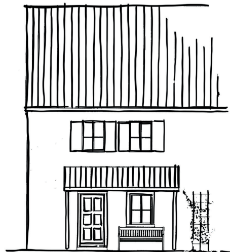
Negativ: Vordach wirkt überdimensioniert, bildet mit dem Gebäude keine Einheit
